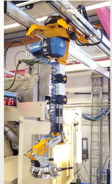
Teleskop -Achse mit Servo Antrieb, Traglast 350 kg, Einsatz Beladung von Turbinen-Blisks
