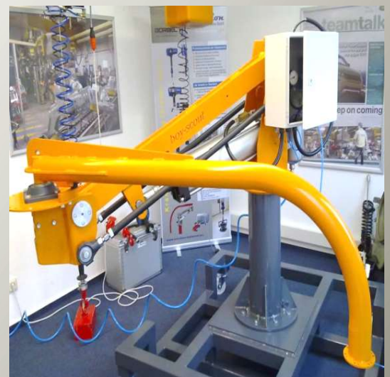
Parallelogramm mit 80 kg Traglast, R=3200mm, Luftbalancer auf mobiler Plattform; Einbau von Netzteilen im ICE
