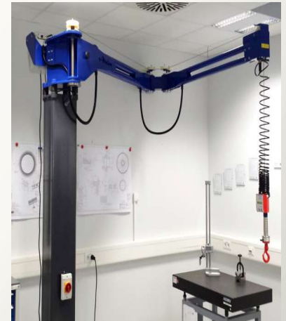
Knickarm-Manipulatoren Höhe 2200 mm, eM 60 Balancer, Tragkraft 80 kg, Radius 4000 mm
