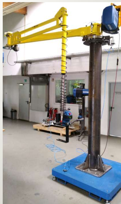
Knickarm-Manipulatoren, R= 4000 mm, Traglast 45 KG; mit Drehmomentstütze
