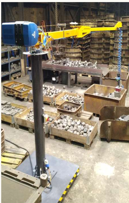
Knickarm-Manipulatoren, R= 4000 mm, Traglast 45 KG; mit pneum. Greifer für Kühlsteine
