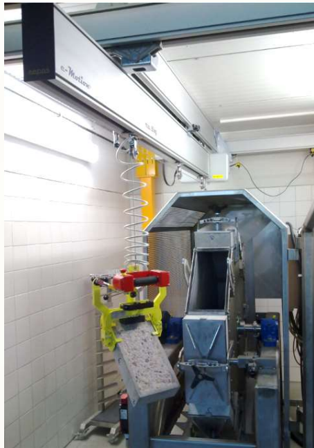
Einbau telekopierende Brücke in Schallschuttkabine zur Steinaufnahme außerhalb der Kabine zur Be- und Entladung der Versuchsanlage.
