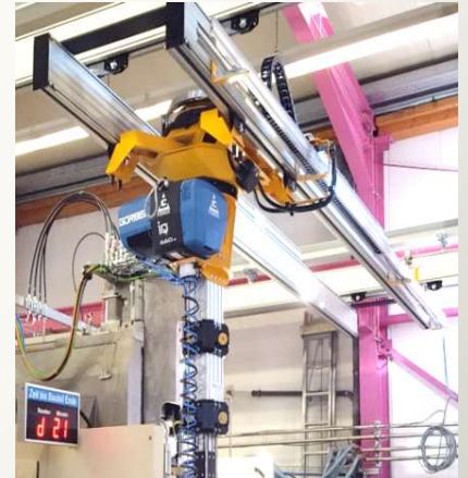
Freistehendes Portal Doppelbrücke zur Aufnahme Z-Achse mit G-Force Balancer Antrieb (350 kg)
