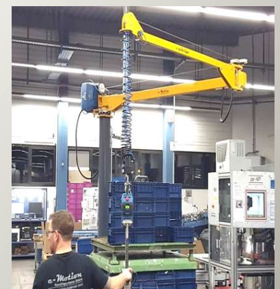
Knickarm- Manipulatoren, R= 4800 mm, Traglast 35 KG; mit pneum. Greifer für KLT-Box
