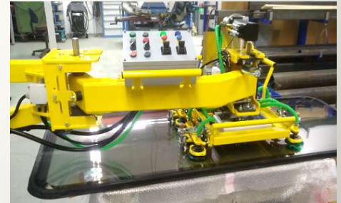
Vakuum- Schwenkgreifer für die Scheibenmontage
