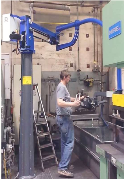
Parallelogramm mit 100 kg Traglast, R=4000 mm, mit Servo-Spindeltrieb Hub 1.500 mm
