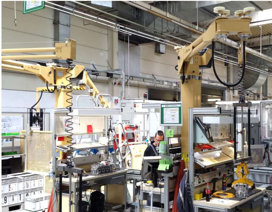
Knickarm-Manipulatoren mit Drehgriff-Hebehilfe , Tragkraft 80 kg, Radius 3200 mm
