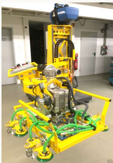
Hub-Achse mit Servo Antrieb, Traglast 150 kg, Hub 1000mm, mit Servo Schwenkantrieb, Scheibenmontage
