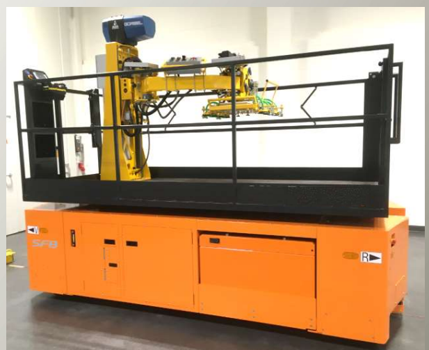
Fahrzeug mit Scherenhubtisch zur Aufnahme der Hub-Achse; alle Antriebe werden über den Bordakku mit 48V/DC betrieben
