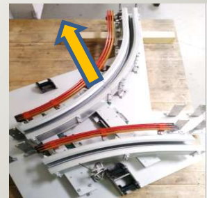
Aluminiumprofil Schienenweiche mit Stromversorgung
