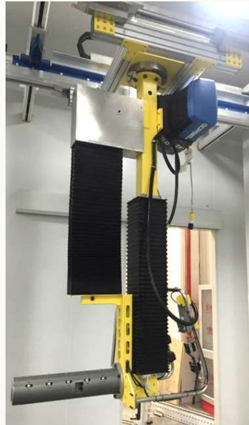
Hub-Achse mit Servo Antrieb, Traglast 150 kg, Einsatz zum Beladen von Anoden-Folien
