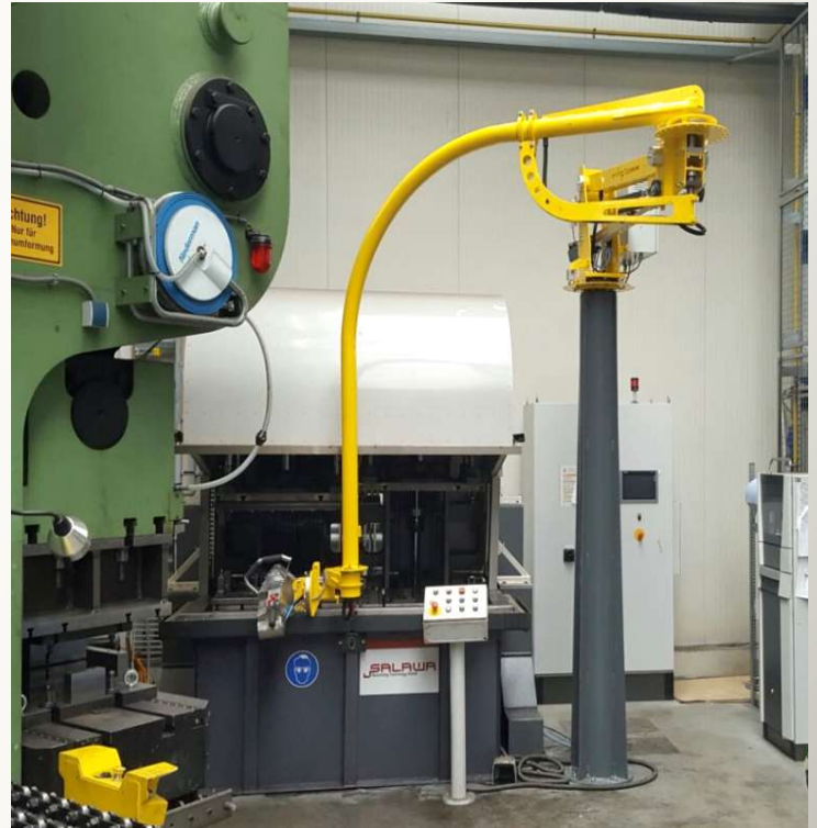
Parallelogramm mit 100 kg Traglast, R=4500 mm, mit Servo-Spindeltrieb Hub 1.200 mm
