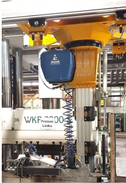
Teleskop Achse mit Servo - Balancer- Antrieb, Momentaufnahme bis 500Nm, Einsatz im abhängendem Aluminium Schienensystem
