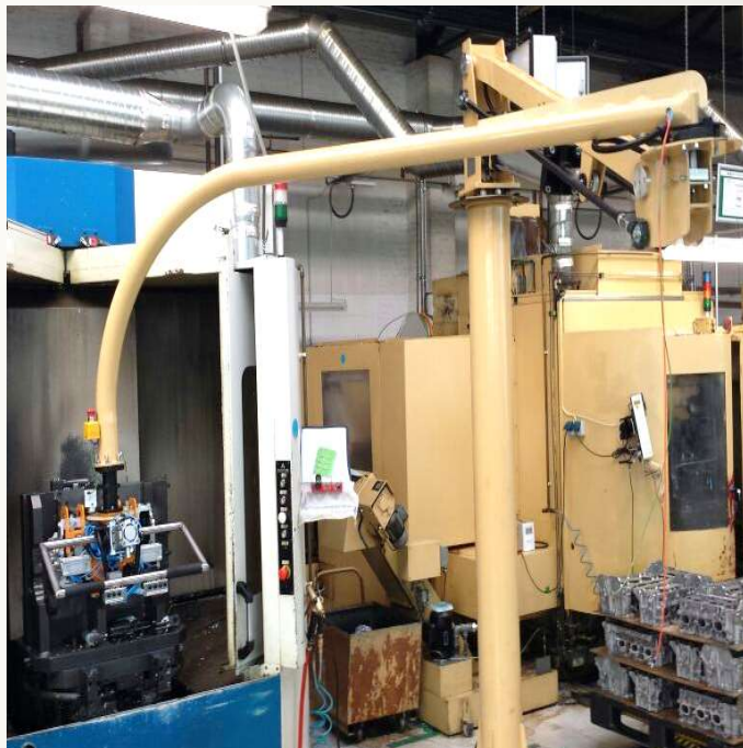
Parallelogramm mit 100 kg Traglast, R=4500mm, Luftbalancer und Positionsbremsen
