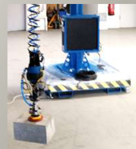
mit Vakuum- pumpe und USV-Betrieb
