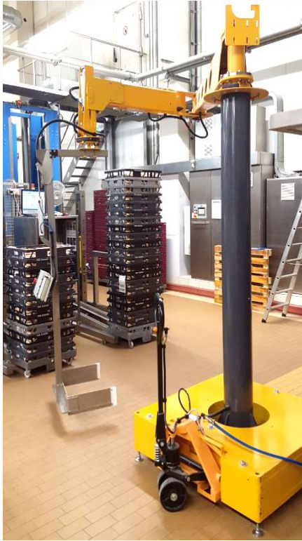
Knickarm-Manipulator, verfahrbar Traglast 150 kg, R3500mm, pneumatischer Hub zum Anheben von Tray-Stapel bis 250 mm
